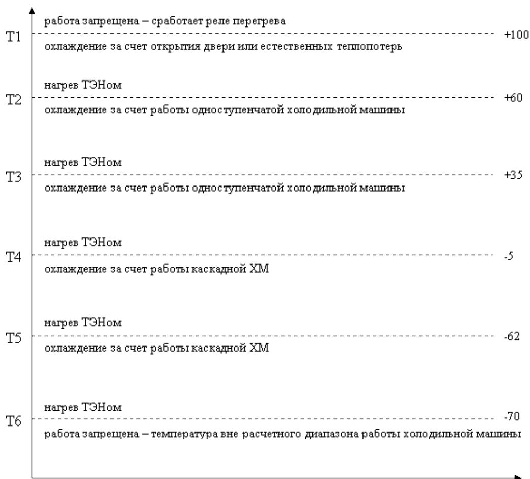
Рисунок 4 – Температурные зоны работы устройств камеры
