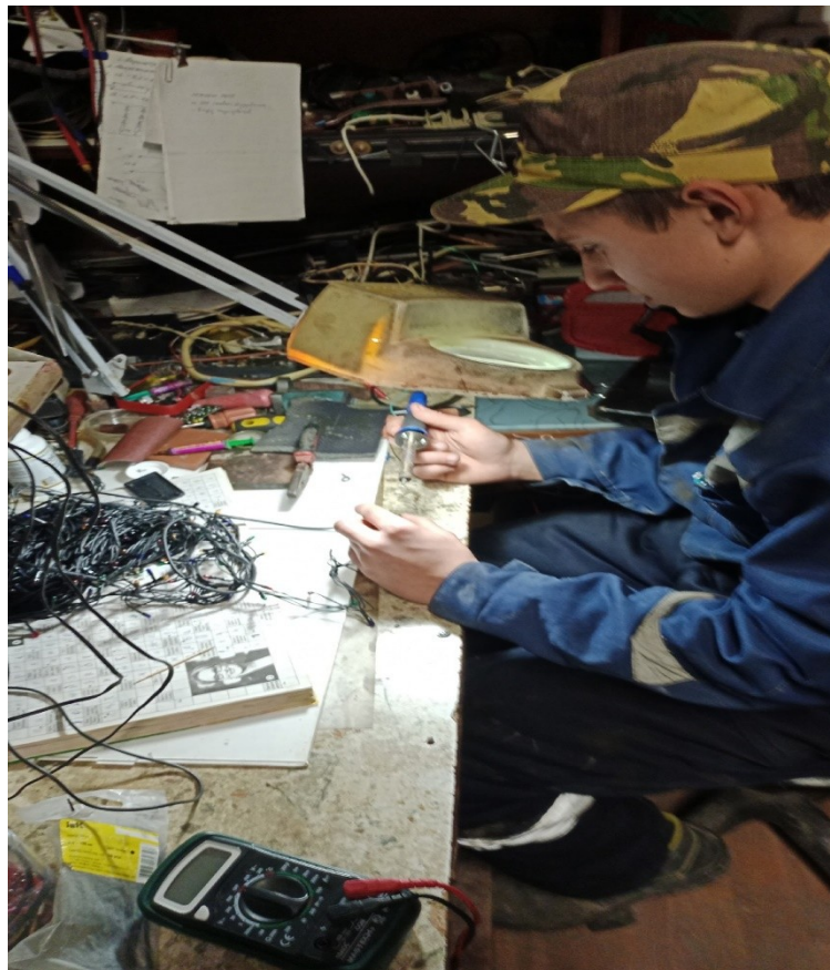
Замена предохранителя при помощи паяльника.
