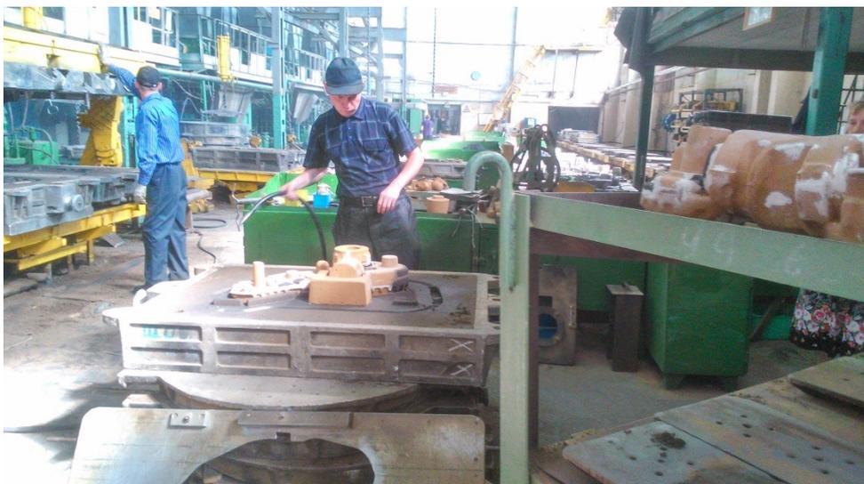
Облицовка модельных блоков и получение керамических форм- важная часть технологического процесса литейного цеха. Перед заливкой керамические формы прокаливаются в печах. Керамическая форма прокалена- далее её ждёт заливка сплавом. На фото снизу залитая сплавом керамическая форма.
