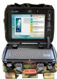
АРМ автономной видеоконференцсвязи является совокупностью аппаратных и программных средств, конструктивно смонтированных в переносном пластиковом водонепроницаемом ударопрочном кейсе классом защиты IP-67, оснащённом автоматическим клапаном выравнивания давления, и предназначено для обеспечения организации видеоконференцсвязи в качестве выносного терминала, а также организации видеонаблюдения при работе по цифровым каналам связи (IP-сетям).
