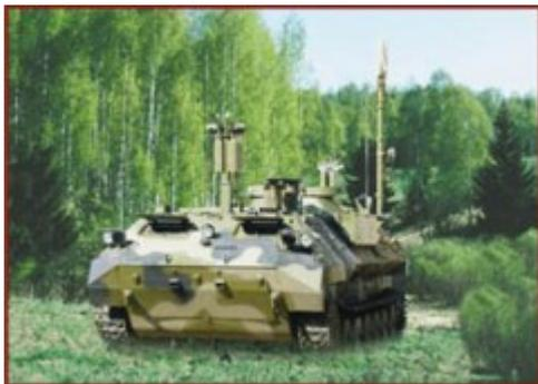
Модуль планирования (МП) на гусеничном шасси 9С931 предназначен для оснащения командного пункта (КП) зенитно-ракетных формирований полкового уровня и командного пункта зенитного дивизиона современными средствами автоматизации, связи и обмена данными с целью обеспечения эффективности управления силами и оружием подразделений противовоздушной обороны (ПВО), координации их действий, повышения мобильности и живучести при любых условиях боевой обстановки.
