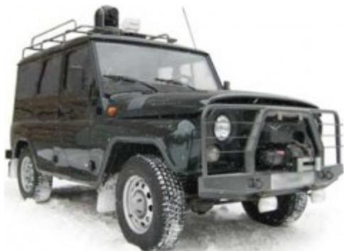
Мобильный комплекс предназначен для мониторинга и контроля наземной обстановки в светлое и темное время суток.
