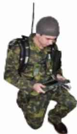
Носимый терминал средств поражения (НТСП) 83т289-1.11 служит для включения командира противотанкового артиллерийского орудия (расчета переносного противотанкового ракетного комплекса) в единый контур автоматизированного управления артиллерийским взводом (взводом переносных противотанковых ракетных комплексов).
