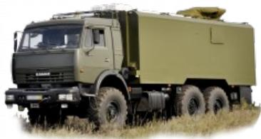
Мобильный пункт управления на базе автомобиля КАМАЗ (МПУС-К) предназначен для использования руководством регионального уровня на выездных мероприятиях и обеспечивает получение, обработку, хранение и отображение информации, информационный обмен с внешними абонентами, доступ к каналам спутникового телевидения, телефонную связь.
