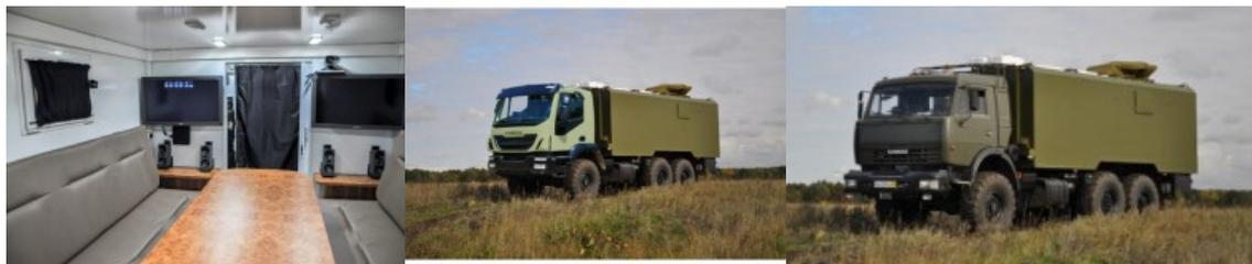
Мобильный пункт управления (МПУ) автономный на шасси автомобиля «КАМАЗ», «IVECO» (или аналогичном) предназначен для предоставления должностным лицам мультисервисных услуг связи (передачи данных, видеоконференцсвязи, телефонии) по спутниковым и проводным (медным и оптоволоконным) каналам передачи данных из районов (мест), не подготовленных в отношении связи. Основная задача, выполняемая изделием, обеспечение связью должностных лиц при охране периметров объектов.
