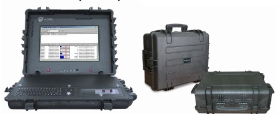
АРМ «И-300М» – автоматизированное рабочее место, предназначенное для организации обмена данными (текст, фотографии, аудио, видео) с аналогичным АРМ по телефонным линиям связи общего пользования (ТФОП), выделенным линиям связи и цифровым каналам связи (IP-сетям) с использованием специальной аппаратуры закрытия.
