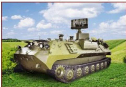
Модуль разведки и управления на гусеничном шасси с РЛС (МРУ-Б) 9С932-1 предназначен для оснащения батареинного командирского пункта (БКП) тактических воинских формирований (ТВФ) противовоздушной обороны (ПВО) современными средствами автоматизации, связи и обмена данными с целью обеспечения эффективности управления силами и оружием ПВО, координации их действий, повышения мобильности и живучести при любых условиях боевой обстановки.
