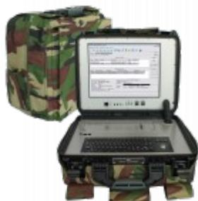
Программно-аппаратный комплекс (ПАК) «АРМ «СПЕКТР» предназначен для организации автоматизированного защищенного обмена документальной и речевой информацией между типовыми (аналогичными) изделиями по IP-сетям с использованием специальной аппаратуры закрытия.
