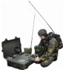
Выносной командно-наблюдательный пункт командира взвода (ВКНП КВ) 83т289-1.10 предназначен для наблюдения за местностью и ведения разведки в дневных и ночных условиях, автоматизированного управления противотанковым артиллерийским взводом и взводом переносных противотанковых ракетных комплексов, организации открытой и закрытой связи и обмена сообщениями с расчетами ПТП и ПТРК, а также вышестоящими КНП.
