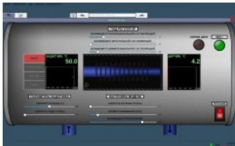
SCADA «УРАЛ-Атом» — это инструментальная программа, обеспечивающая создание программного обеспечения для автоматизации контроля и управления технологическим процессом в режиме реального времени. Основная цель создаваемой с помощью SCADA программы — дать оператору, управляющему технологическим процессом, полную информацию об этом процессе и необходимые средства для воздействия на него.
