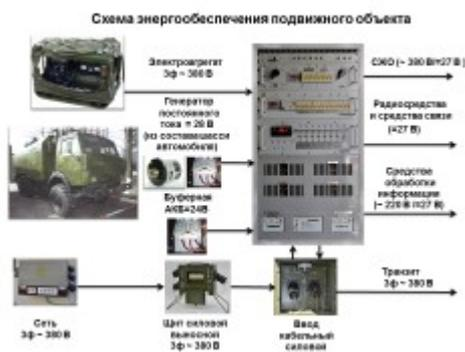
Изделие представляет собой комплект системообразующего электротехнического оборудования для создания одноканальной системы электроснабжения подвижных объектов управления и связи различного функционального назначения, размещаемого на наземном транспортном средстве.
