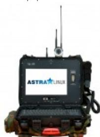
Изделие «ПД-300» обеспечивает обмен конфиденциальной и открытой информацией по телефонным линиям связи общего пользования (ТФОП), выделенным линиям связи, цифровым каналам связи (IP-сетям), радиоканалу (УКВ-диапазона), каналам сотовой и спутниковой связи при развертывании абонентских пунктов органов военного управления МО РФ в глобальной информационной сети (ГИС) в полевых условиях.
