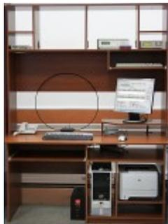
Программно-аппаратный комплекс (ПАК) «АРМ «Веста-В» предназначен для организации автоматизированного обмена документальной и речевой информацией по телефонным линиям связи общего пользования, выделенным линиям связи, линиям радиорелейной связи, IP-сетям, цифровым каналам связи и т.п. с использованием специальной аппаратуры закрытия.
