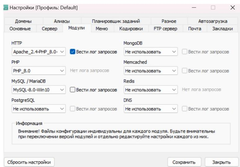
Рисунок 1 – Настройка модулей *OS Panel*
