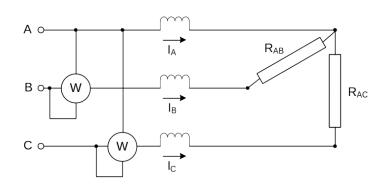
Схема включения ваттметров в цепь при обрыве одной фазы приемника энергии
