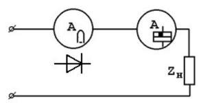
1. Магнитоэлектрический амперметр при токе  $I=I_{1m}*sin\omega t+I_{3m}*sin(3\omega t+\psi_3)$  измеряет постоянную составляющую
