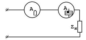
1. Электродинамический амперметр при токе  $I=I_0+I_{1m}*sin\omega t+I_{3m}*sin(3\omega t+\psi_3)$
