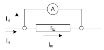
Схема включения измерительного прибора с шунтом в случае масштабирования по току
