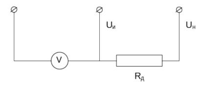
Схема включения измерительного прибора с добавочным сопротивлением
