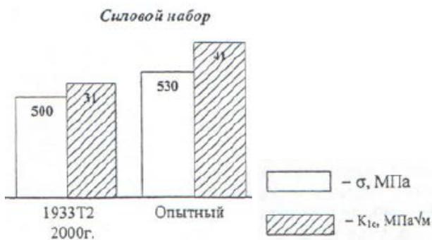
Рис. Прочностные хар-ки и коэф.статической трещиностойкости алюминиевых сплавов для силового набора
