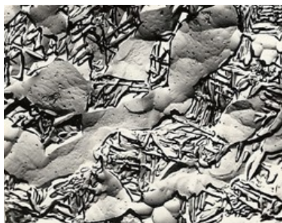
а) нагрев до 1000^{\circ}\text{C} , выдержка 30 минут, охлаждение со скоростью ( v > v_{кр}^I ) до нормальной температуры, старение при 600^{\circ}\text{C} , выдержка 100 секунд;
