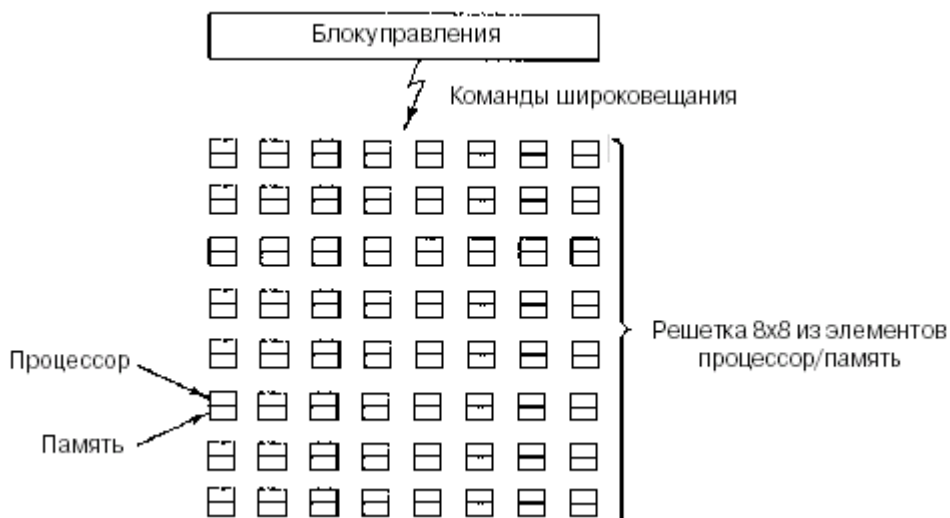
Рисунок 2.6 - Массивно-параллельный процессор ILLIAC IV
