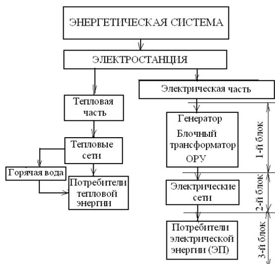
Рисунок 7 – Схема системы электроснабжения
