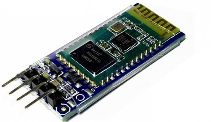
Bluetooth модуль HC-06 предназначен для беспроводного соединения контроллеров Arduino с другими устройствами, таких как телефон, ПК и другие совместимые Bluetooth устройства. Подключение Bluetooth HC-06 к Ардуино производится по UART к выводам RX и TX.
