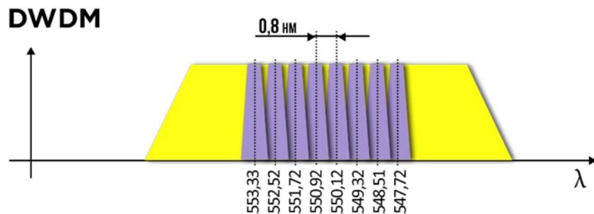
**DWDM** — «плотное спектральное уплотнение» (Применение до **160 волн** для точного спектрального уплотнения. Диапазон несущих частот от 1530 нм до 1605 нм.)
