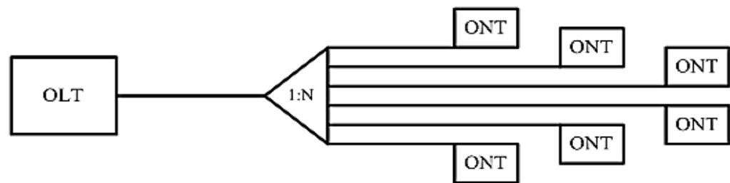
Одноуровневая (однокаскадная) схема
