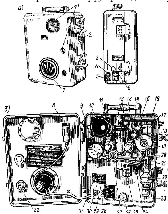
Рис. 3. Автоматический газосигнализатор ГСП-1
