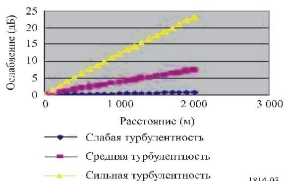
Рис. 2.3. Изменение ослабления из-за мерцания в зависимости от расстояния, для разных типов турбулентности на 1550 нм
