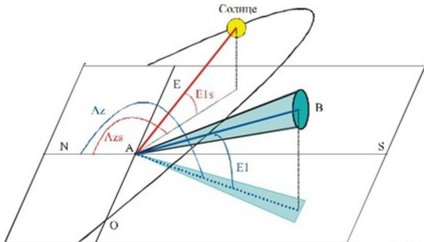
Рис. 2.4 Схема пути движения солнца относительно оптической линии для связи в свободном пространстве
