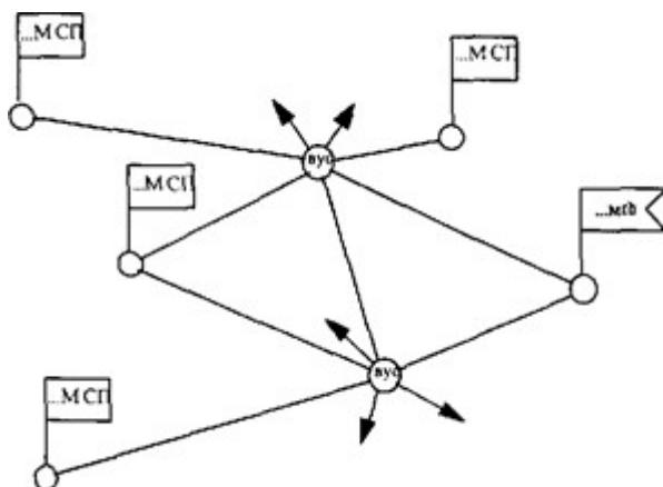
Рис 3.4. Построение системы связи по принципу организации связи через вспомогательные узлы связи
