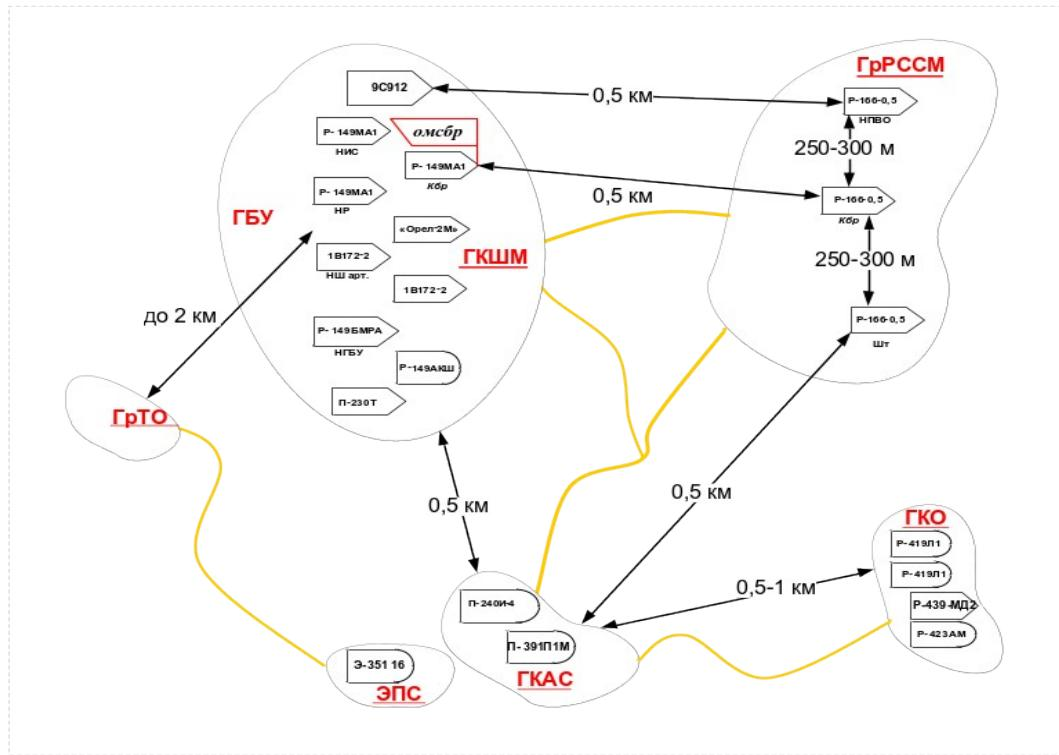
Рис 3.2. Типовое построение аппаратных, характерных для ПУС
