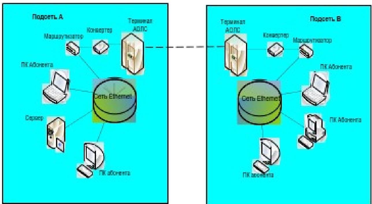
Рис. 2.3. Один из вариантов подключения канала АОЛС между двумя подсетями.
