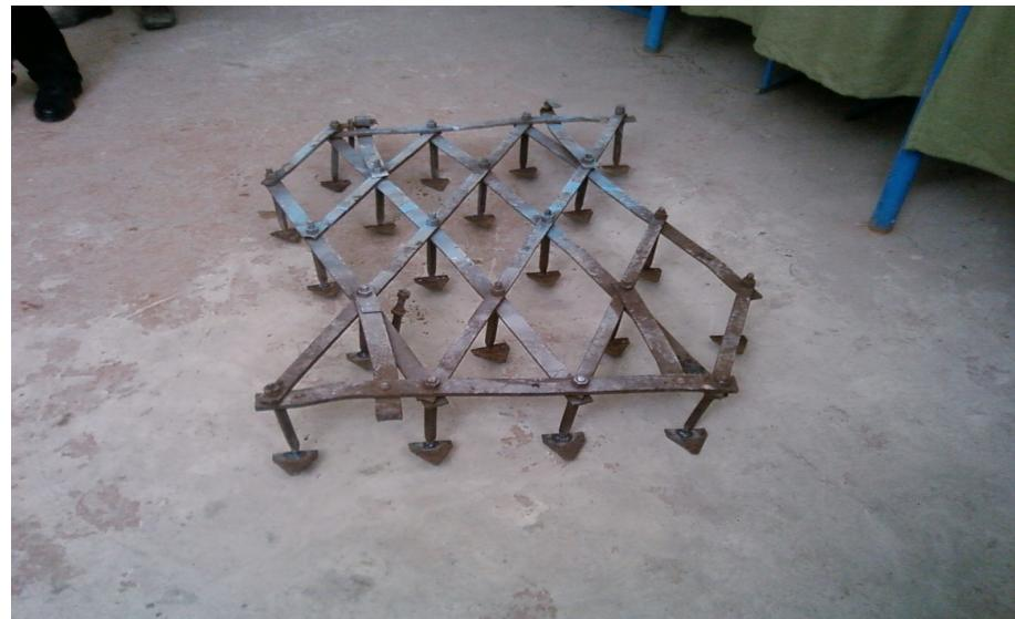
Рис.2 Переоборудованный бороновальный агрегат для поверхностной обработки почвы
