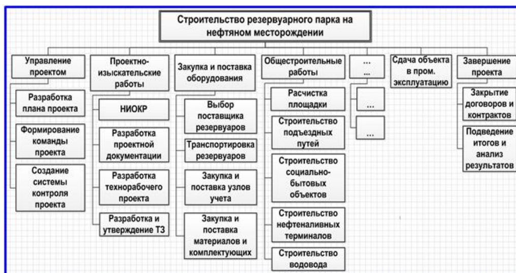
Пример функциональной иерархической структуры
