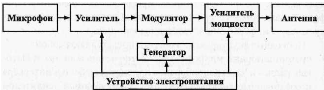
Рис. 2.31. Схема акустической закладки
