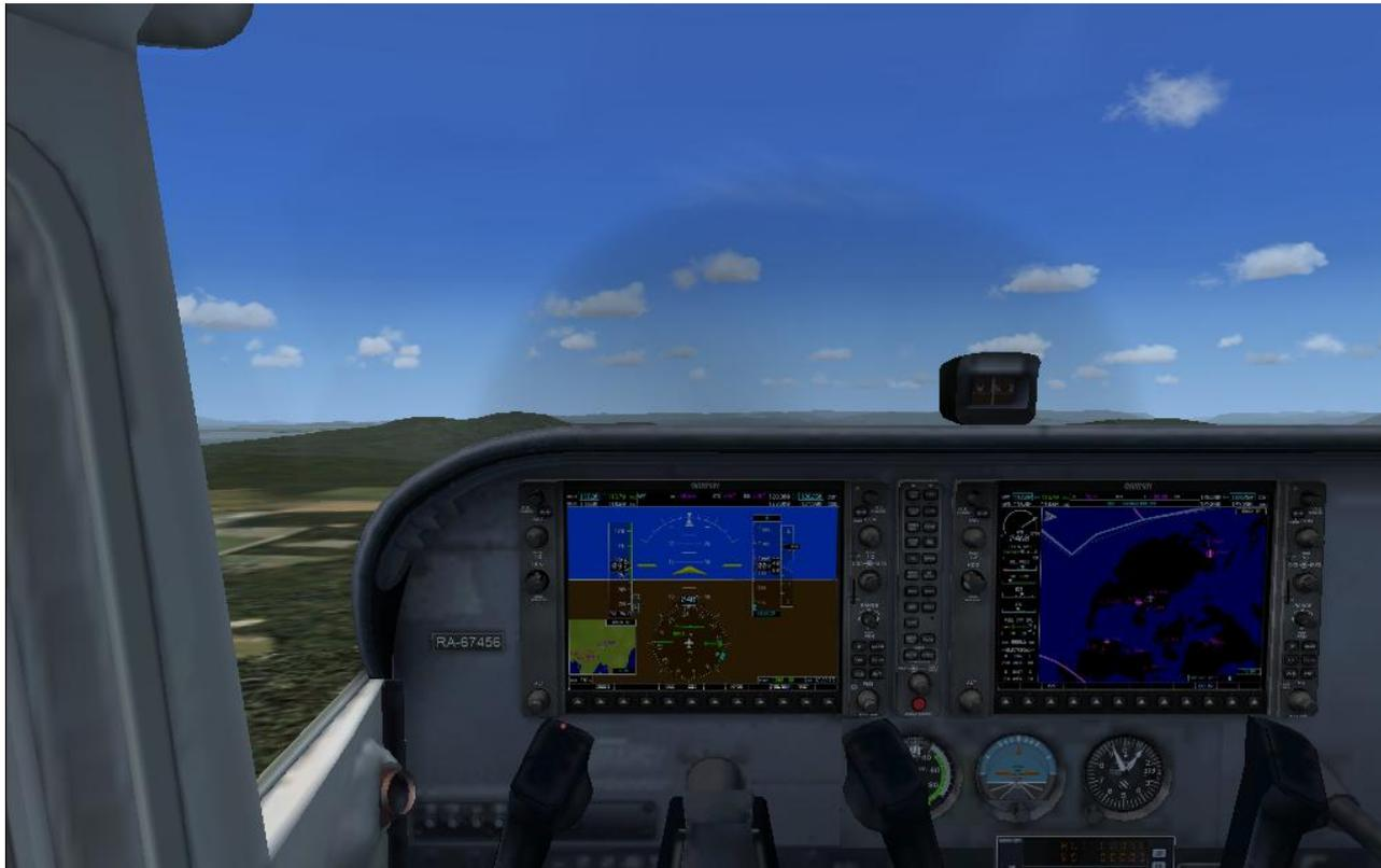
набор высоты, одновременно перевести взгляд вперед на горизонт и капот, имея в поле зрения ориентир направления взлета. Набор высоты производится на скорости **70** узлов при угле тангажа **7,5-10°**.
