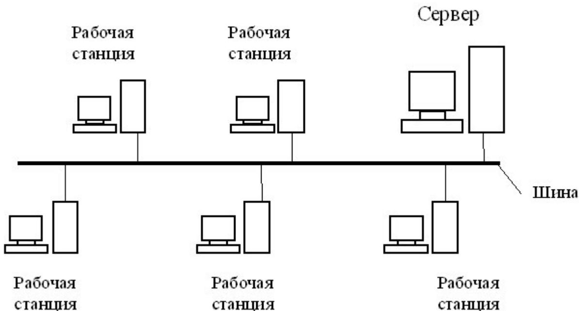
Передача информации в данной сети происходит следующим образом. Данные в виде электрических сигналов передаются всем компьютерам сети. Однако информацию принимает только тот компьютер, адрес которого соответствует адресу получателя. Причем в каждый момент времени только один компьютер может вести передачу данных.
