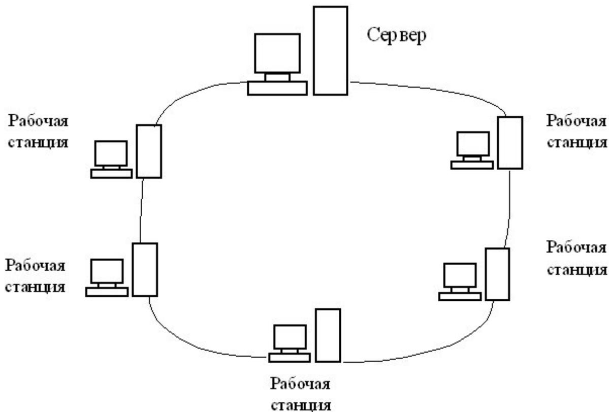
Передача информации в такой сети происходит следующим образом. Маркер (специальный сигнал) последовательно, от одного компьютера к другому, передается до тех пор, пока его не получит тот, которому требуется передать данные. Получив маркер, компьютер создает так называемый "пакет", в который помещает адрес получателя и данные, а затем отправляет этот пакет по кольцу. Данные проходят через каждый компьютер, пока не окажутся у того, чей адрес совпадает с адресом получателя.
