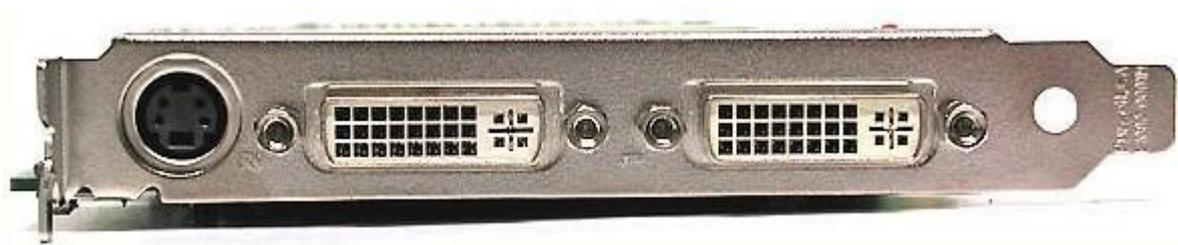
Графическая карта с двумя портами DVI может работать одновременно с двумя (цифровыми) мониторами.
