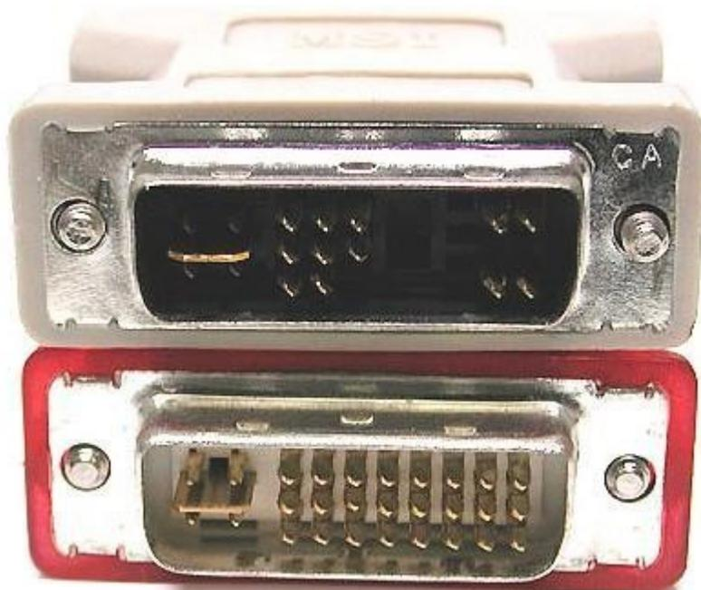
DVI является интерфейсом монитора, разработанным, главным образом, для цифровых сигналов. Чтобы не требовалось переводить цифровые сигналы графической карты в аналоговые, а затем выполнять обратное преобразование в дисплее.
