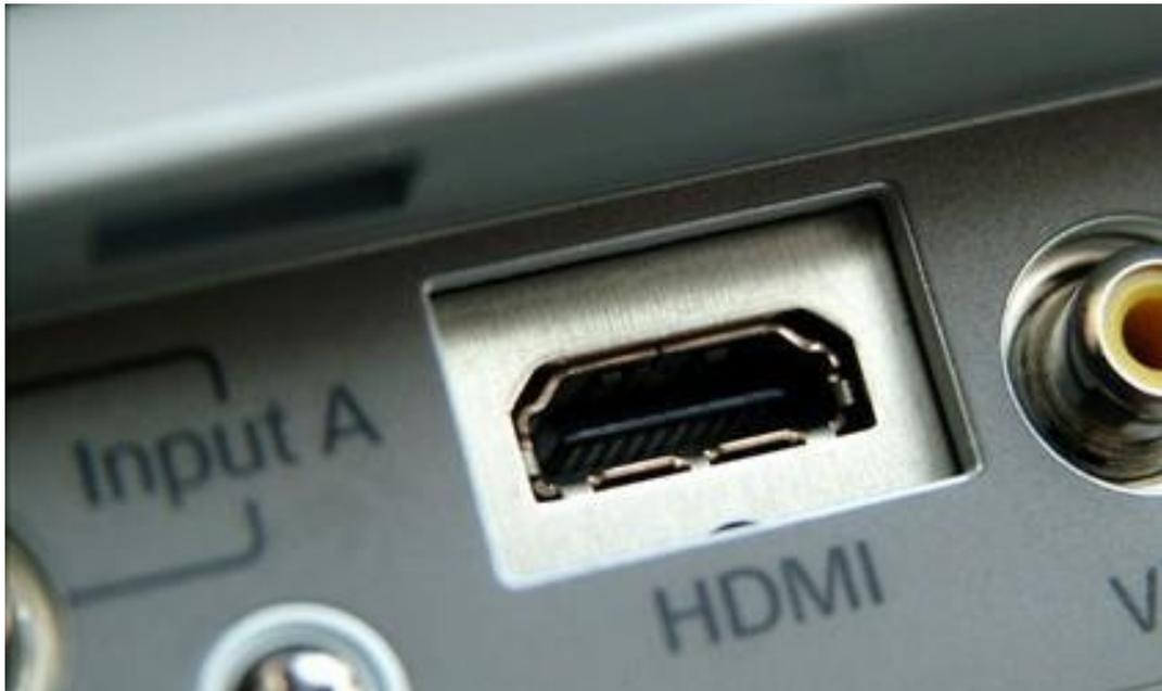
Перед нами цифровой мультимедийный интерфейс для несжатых HDTV-сигналов с разрешением до 1920x1080 (или 1080i), со встроенным механизмом защиты авторских прав Digital Rights Management (DRM). Текущая технология использует вилки типа A с 19 контактами.
