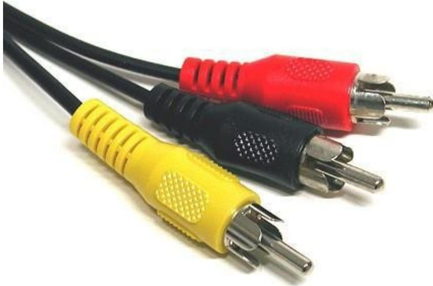
Вилки "тюльпан" имеют разное цветовое кодирование в зависимости от типа сигнала.
