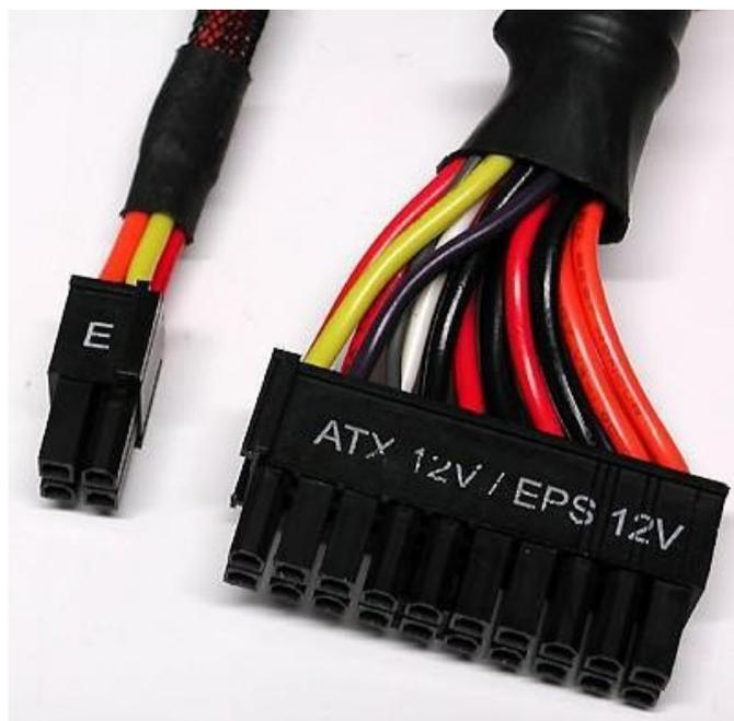
20/24-контактный разъем (ATX и EATX)
