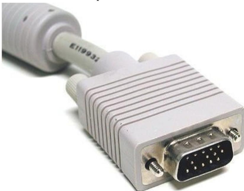
Интерфейс VGA на кабеле монитора.
