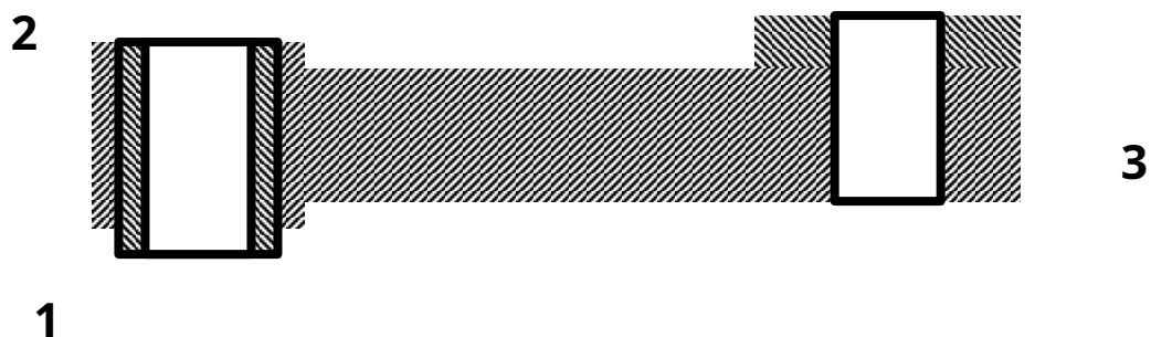
Рис.6 Кондукторная плита Плита; 2 – втулка; 3 – кондукторная втулка
