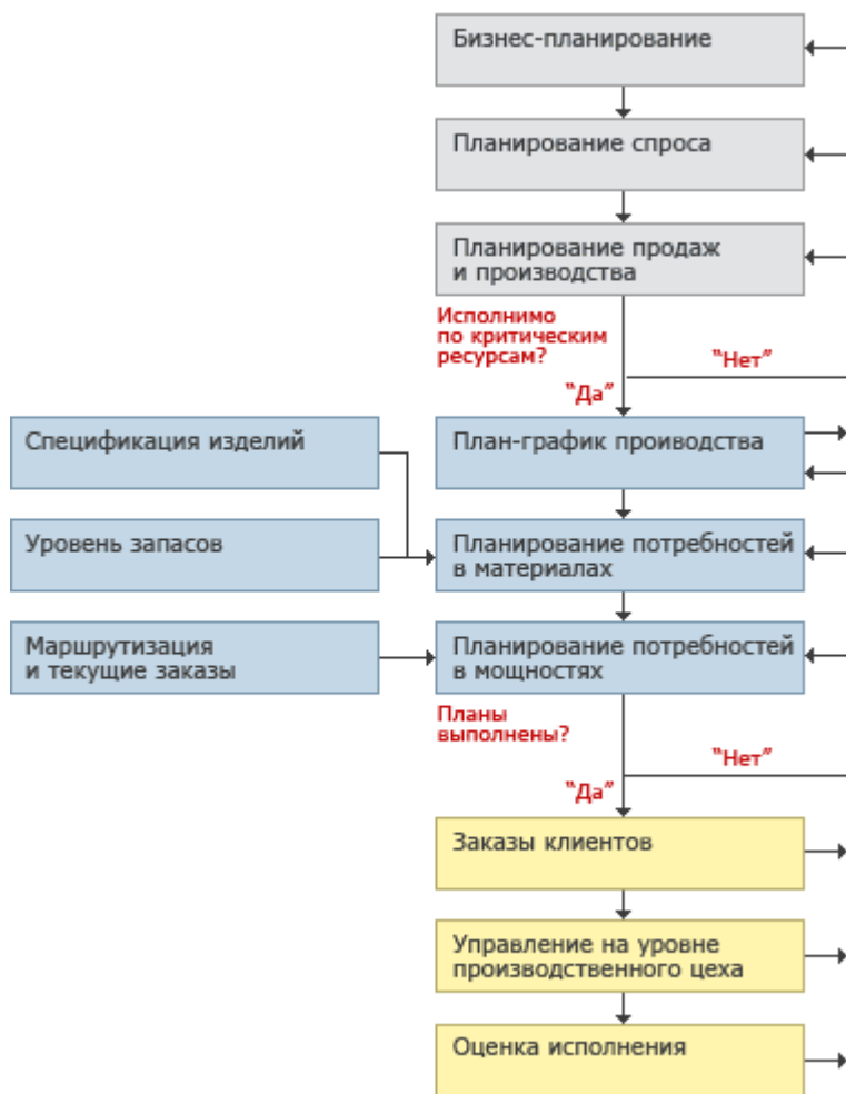
Рис. 2 Алгоритм производственного планирования по стандарту MRP II
