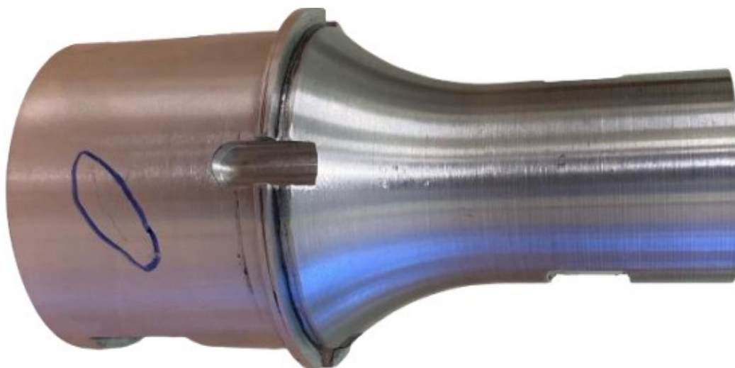
Рисунок 6 – Общий вид волновода 2 с трещиной
