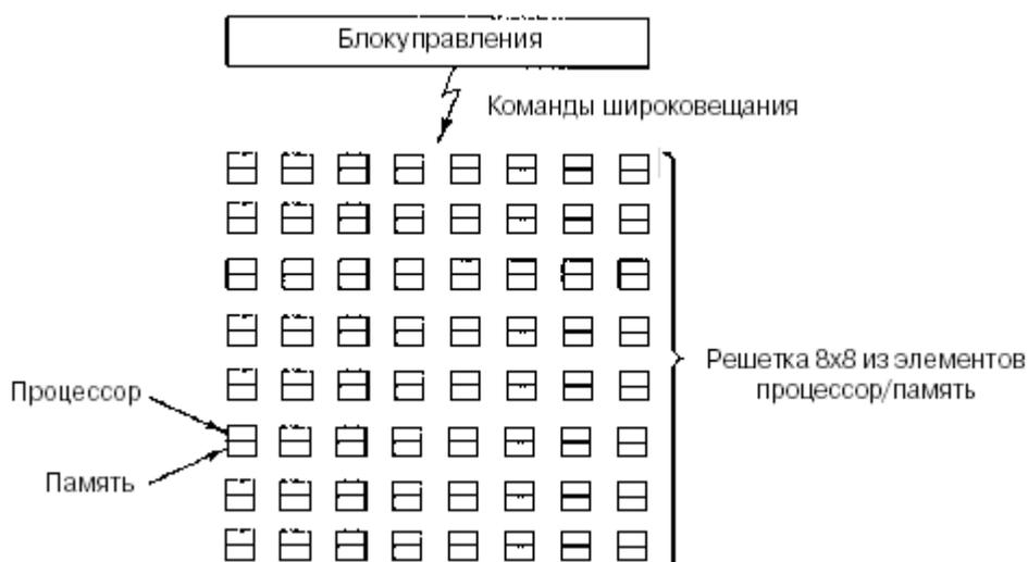
Рисунок 2.6 - Массивно-параллельный процессор ILLIAC IV
