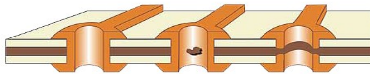
Нормирование качества металлизации сквозных отверстий: слева - отлично; посередине - приемлемо; справа - недопустимо
