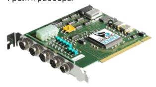
Как правило они объединяют графические, аналогово-цифровые и микросхемы для обработки видеосигналов, которые позволяют дискретизировать видеосигнал,
