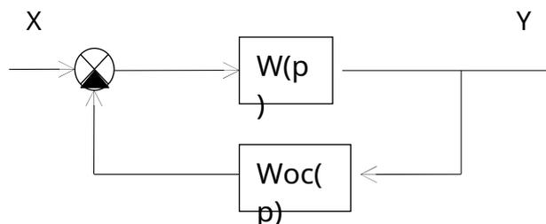
Рисунок 1 – Структурная схема САУ
