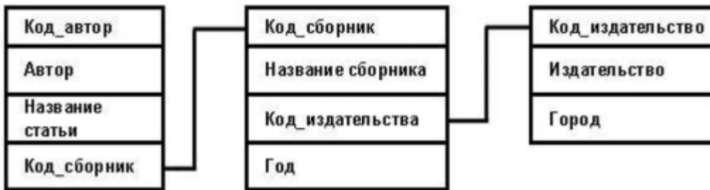
Рис.4. Схематическое представление реляционной БД
