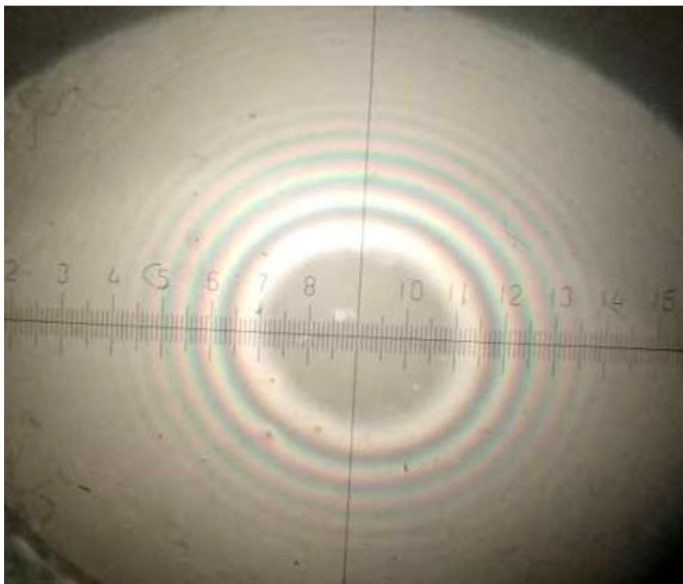
Рисунок 9 - Вид интерференционной картины без светофильтра
