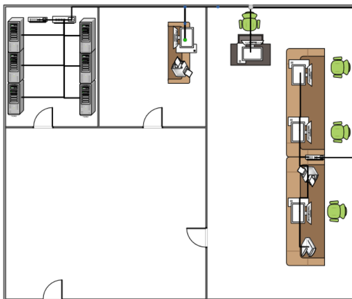
Рисунок 3 Схема прокладки сетевых трасс на предприятии
