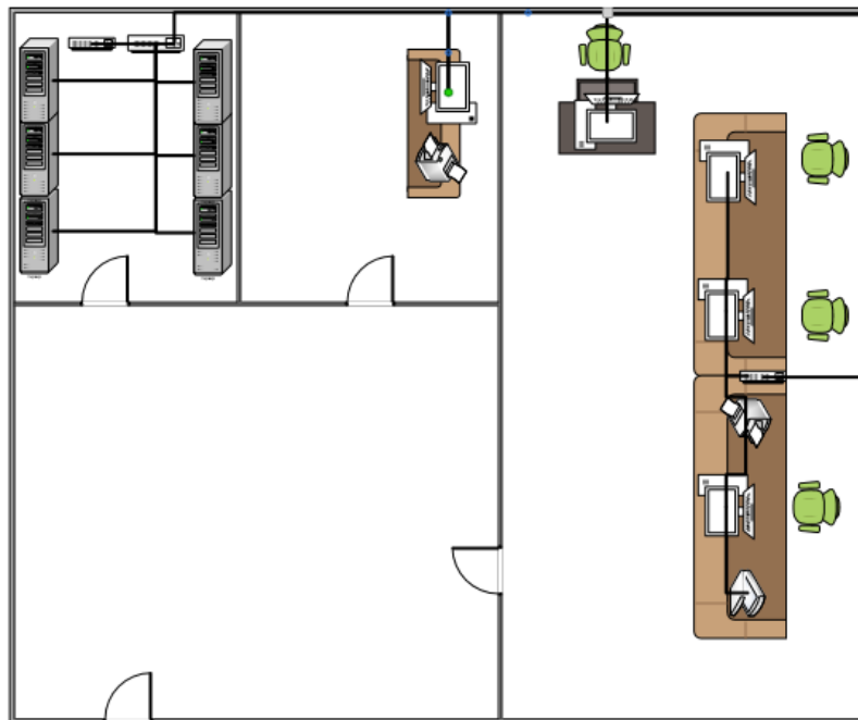
Рисунок 1 Общая схема сети на предприятии
