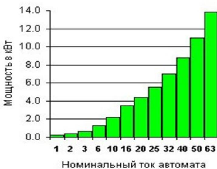
Рисунок 2.2 – График выбора автоматического выключателя по мощности
