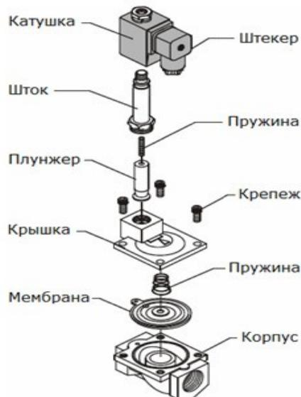
Рисунок 1.2 – Устройство электромагнитного клапана
