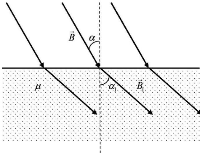
Полупространство, заполненное веществом с магнитной проницаемостью  $\mu$ , отделено от вакуума бесконечной плоскостью. В вакууме имеется однородное магнитное поле с индукцией  $B$ , направление которого составляет угол  $\alpha$  с нормалью к поверхности раздела. Найти модуль индукции  $B_1$  магнитного поля в веществе и угол  $\alpha_1$  между вектором индукции магнитного поля в веществе и нормалью к поверхности раздела.
