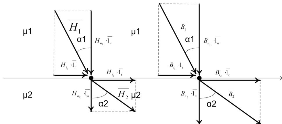
Т.к. в точке на границе 2-х сред нету тока, то касательные составляющие вектора напряженности магнитного поля (следствие первого уравнения Максвелла) в веществе 1 и веществе 2 равны
