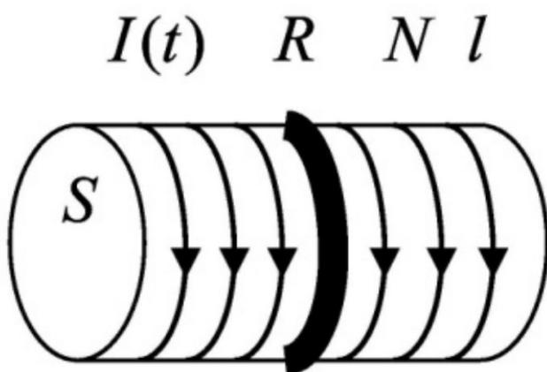
На соленоид длиной  $l=10$  см и площадью поперечного сечения  $S=5$  кв. см надет проволочный виток сопротивлением  $R = 1$  Ом. Обмотка соленоида имеет  $N=500$  витков, и по нему идет ток, сила которого меняется со временем по заданному
