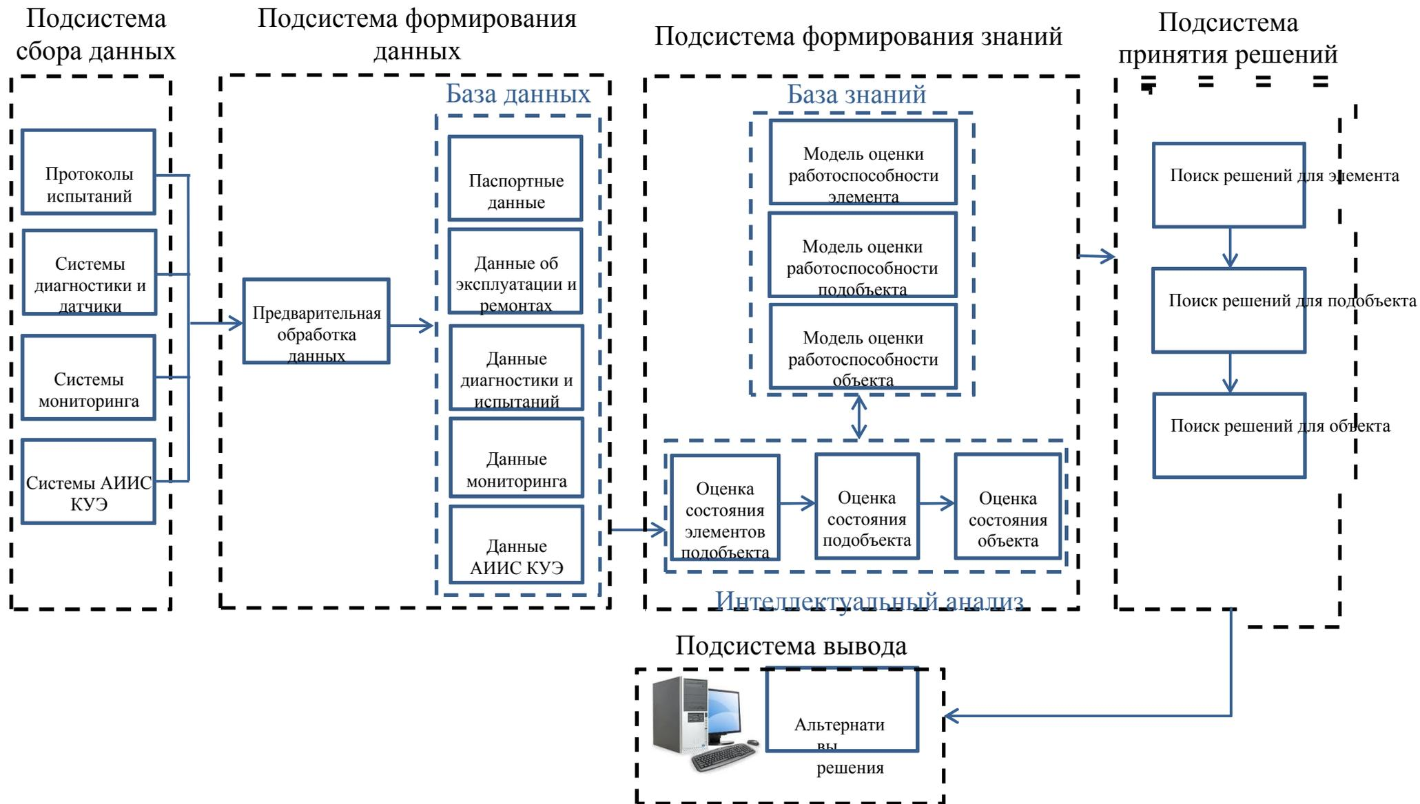
Рисунок 6 – Архитектура системы принятия решений
