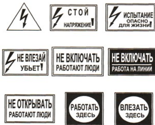
Рис.5.1 Плакаты по требованиям безопасности и знаки безопасности: а ... г – предупреждающие; д, е, ж – запрещающие; з, и – предписывающий.
