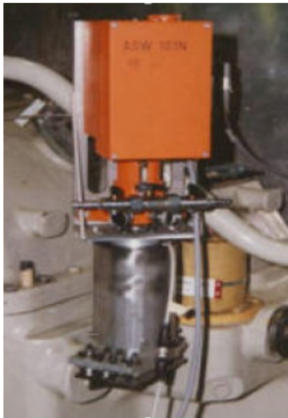
Рисунок 6 – Общий вид автоматизированного гидростатического нивелира ASW101N
