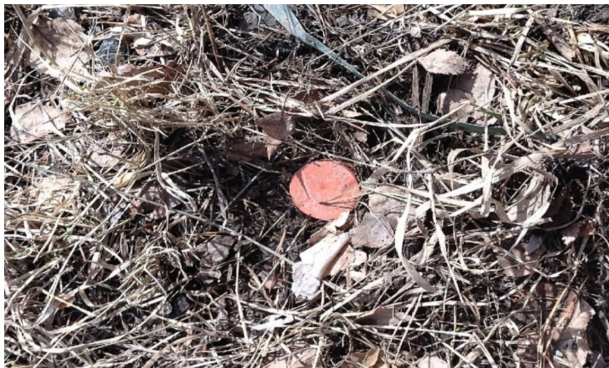
Рисунок 2.1.2.3 – Пробка для обозначения точек стоянки прибора и ориентирования
