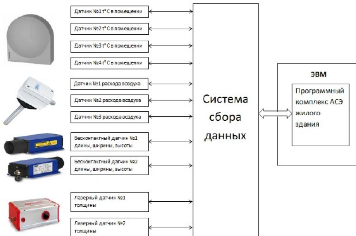
Рисунок 2.1 - Структурная схема разрабатываемой АСЭ
