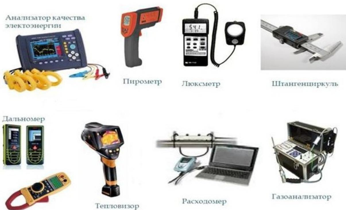
Рисунок 4.1 – Оборудование, используемое для энергетического обследования
