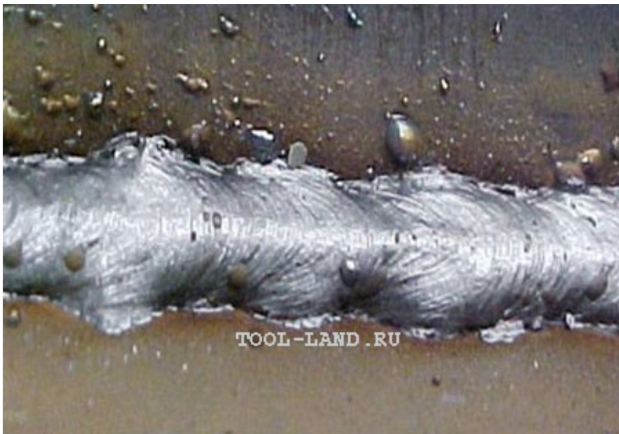
Дефекты сварного шва: наплывы
