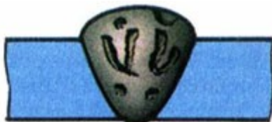
Пористость в сварном шве
