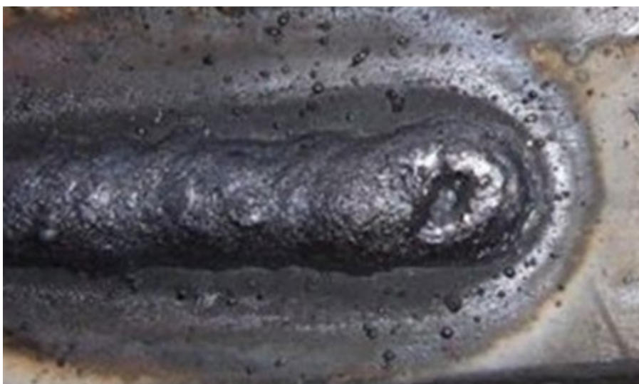
Кратер сварочного шва
