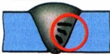
Посторонние включения сварного соединения
