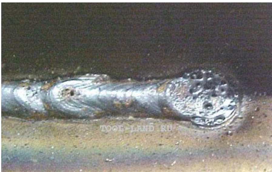
Пористость в сварном шве
