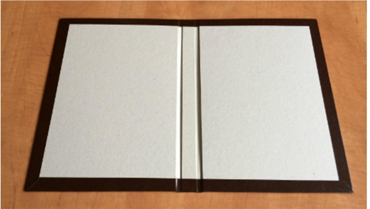
Рисунок 2.7. Переплет с накладными страницами и окантовочным корешком
