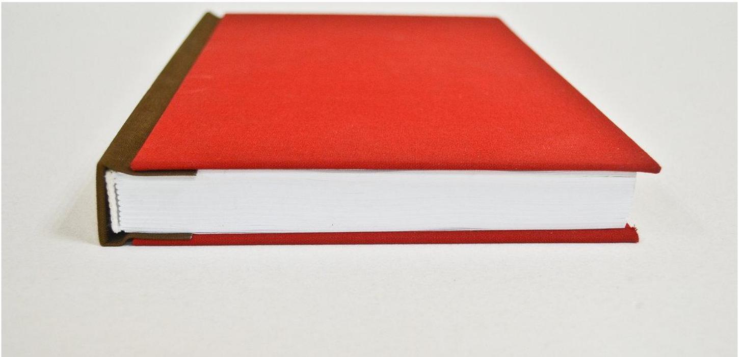
Рисунок 2.8. Переплет с составной крышкой и окантовочным корешком
