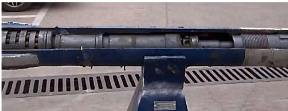
Рисунок 9.5 – Разрез шпindelной секции ВЗД
