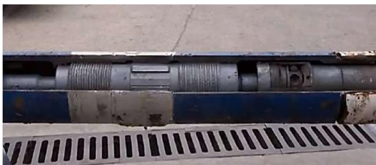
Рисунок 10.2 – Регулятор угла перекоса ВЗД в разрезе
