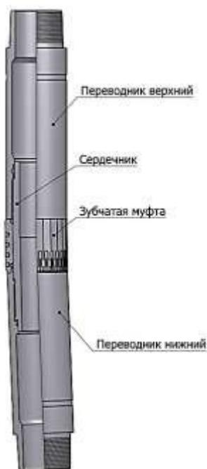
Рисунок 10 – Общий вид регулятора угла перекоса ВЗД
