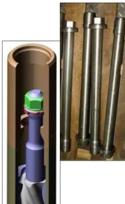
Рисунок 12 – Противоаварийный узел.
