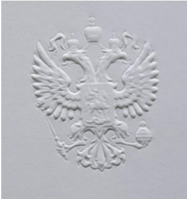
**Рис. 4. Пример конгревного тиснения**
