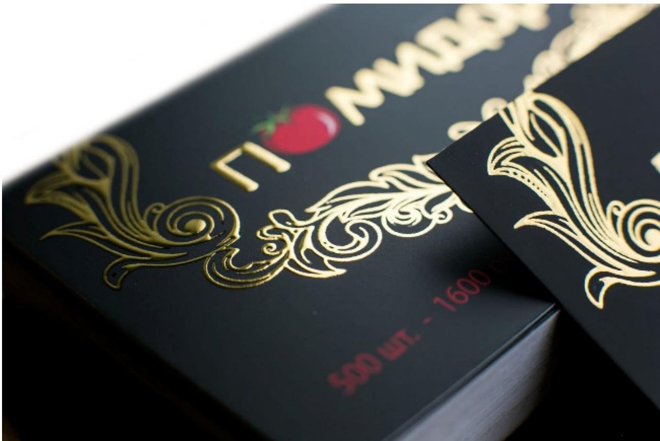
**Рис. 1. Тиснение металлизированной фольгой.**
