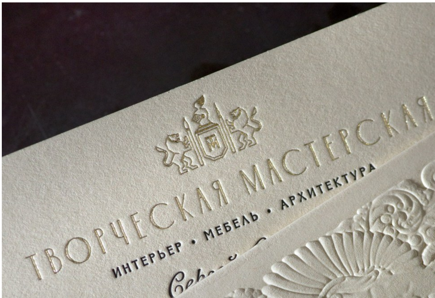
(рис. 3 — конгревное тиснение металлизированной (золотой) фольгой на визитке)
