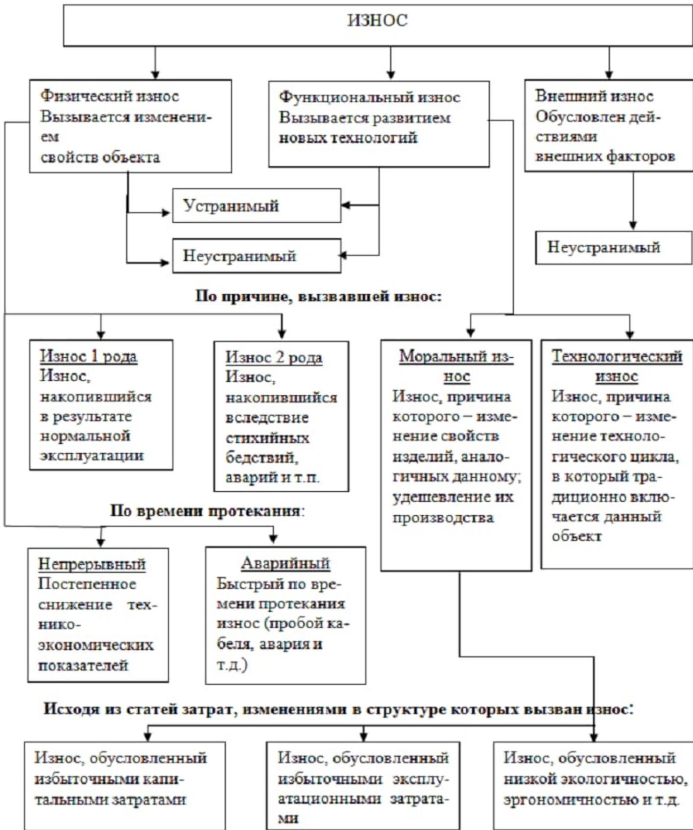
В зависимости от характера внешних воздействий на материалы изделия различают следующие основные виды износа:
