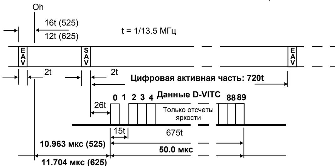
Рис. 3.2.10.2 Временная диаграмма сигнала D-VITS
