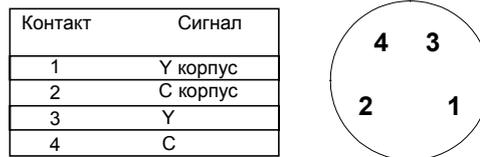
Рис. 3.2.8.1 Соединитель Y/C с разъемом типа Mini-DIN
