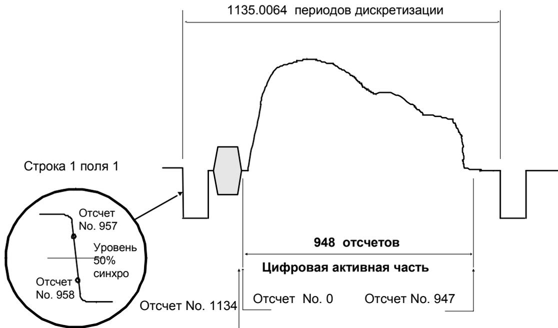
Рис. 3.4.3 Строка цифрового композитного сигнала PAL
