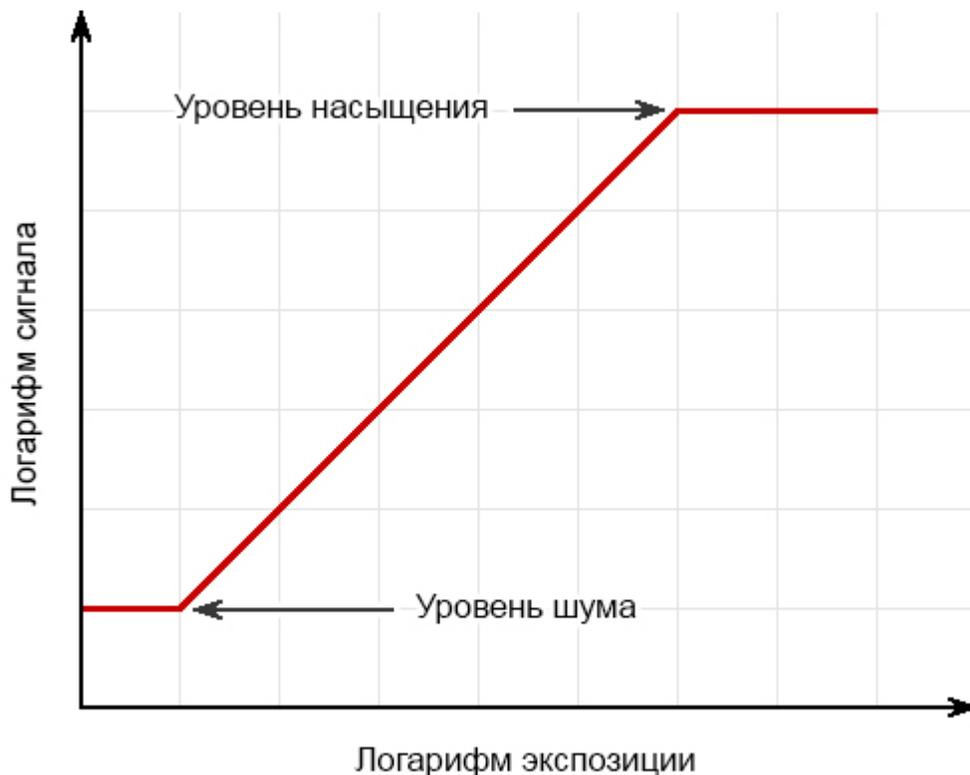
Рисунок 1 - график зависимости выходного сигнала от экспозиции
