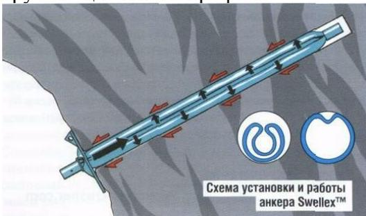
При установке анкера Swellex™ используется принцип гидрораспора трубки.
