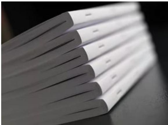
Такой вид переплета, как соединение при помощи скоб, подходит для изготовления брошюр, состоящих из небольшого количества печатных полос. Для обложки подбирается бумага с показателем плотности 160–250 г/м<sup>2</sup>. Потом она соединяется с блоком двумя или тремя металлическими скобами.
