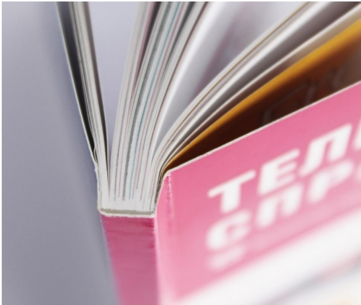
При таком виде переплета обложка приклеивается к книжному блоку. Чтобы kleевое соединение было более крепким, применяется торшенирование – на
