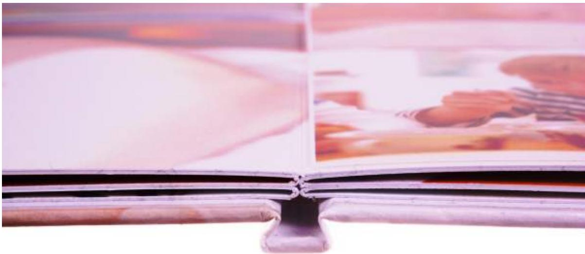
При создании фотокниг используется особый вид переплета. Для него характерны развороты – на одном листе печатаются изображения двух расположенных рядом страниц. Развороты бигутятся, сгибаются по линии корешка, а затем наклеиваются на картонную или пластиковую основу в заданной последовательности.
