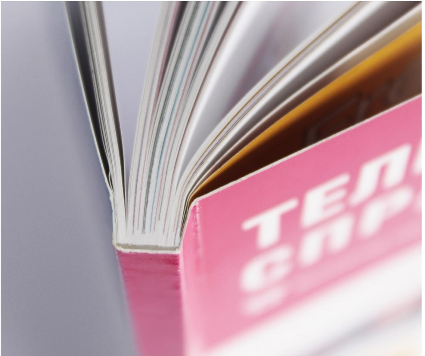
При таком виде переплета обложка приклеивается к книжному блоку. Чтобы клеевое соединение было более крепким, применяется торшенирование – на корешке блока создаются поперечные надрезы, которые в процессе соединения заполняются клеящим составом.
