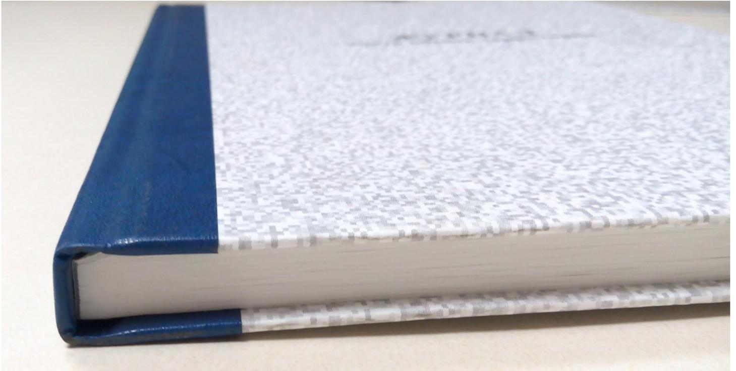
Вид переплета 7Б при изготовлении книжных изданий означает применение бумвинила, кожи, ткани, балакрона, которыми кашируется картон. От 7БЦ он отличается использованием методов тиснения и конгрева, то есть рисунки наносятся с помощью фольги или выдавливаются штампом.
