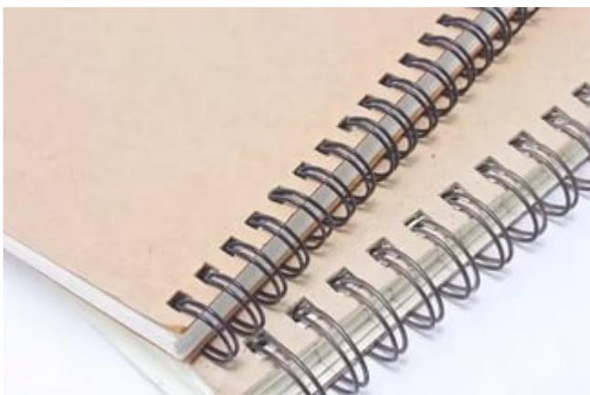
Ведущую роль в создании такого вида переплета играет проволока, сформированная в двойные петли. В процессе соединения страниц специальная машина раздвигает нижний край петель и вставляет их в блоки с заранее проделанными отверстиями, круглыми или в виде квадратов.
