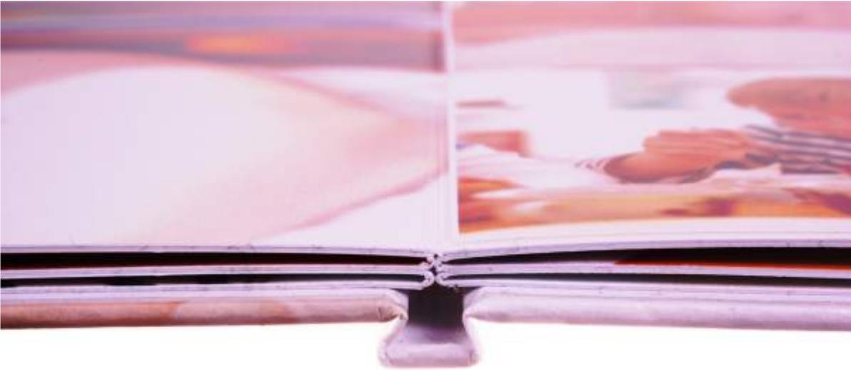
При создании фотокниг используется особый вид переплета. Для него характерны развороты – на одном листе печатаются изображения двух расположенных рядом страниц. Развороты бигуются, сгибаются по линии корешка, а затем наклеиваются на картонную или пластиковую основу в заданной последовательности.
