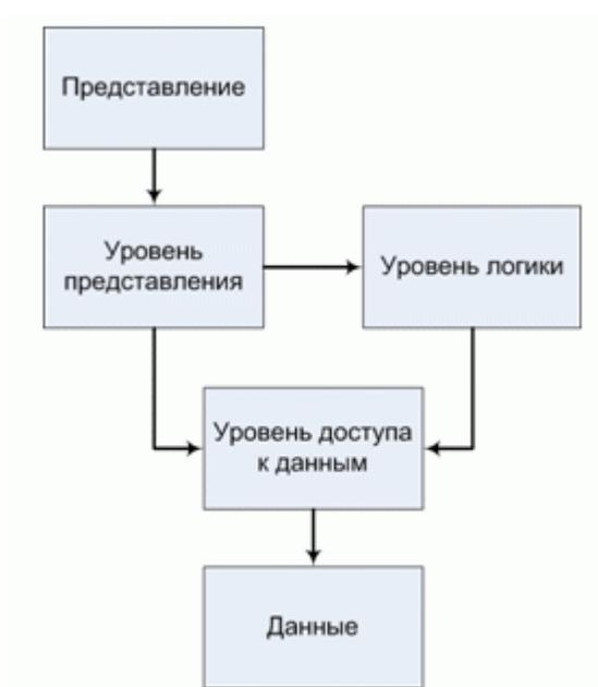
Рис. 6 Пять уровней многозвенной архитектуры "клиент-сервер"
