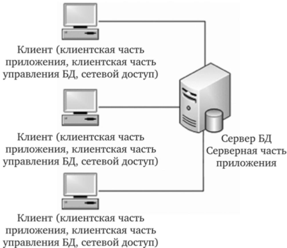
Рис. 4 Классическое представление архитектуры "клиент-сервер"
