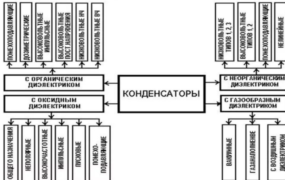
Рисунок 1.2 – Классификация конденсаторов по диэлектрическому слою
